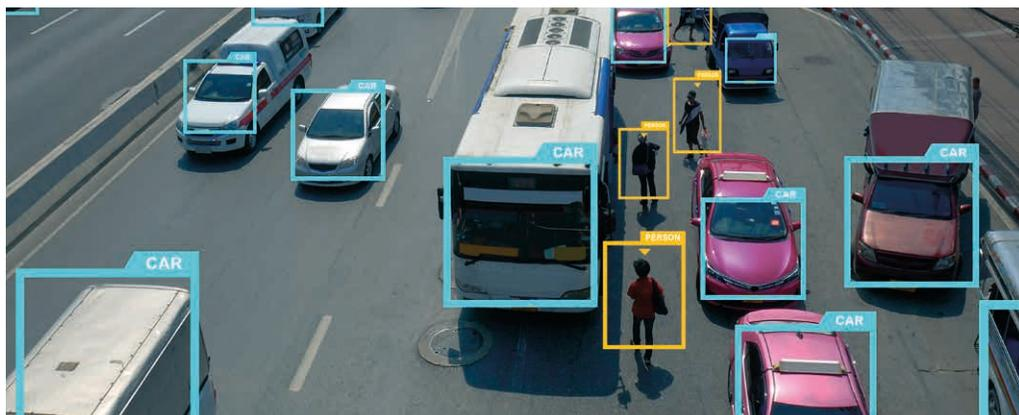
Mit den Kameras der Smart Line von GRUNDIG Security lassen sich Personen und Fahrzeuge eindeutig klassifizieren. Damit können Anwender, zum Beispiel Mitarbeiter in Leitstellen, Alarmereignisse und -reaktionen noch präziser festlegen. Die bidirektionale Audiofunktion erlaubt zudem eine direkte Kommunikation mit den Personen vor Ort.
