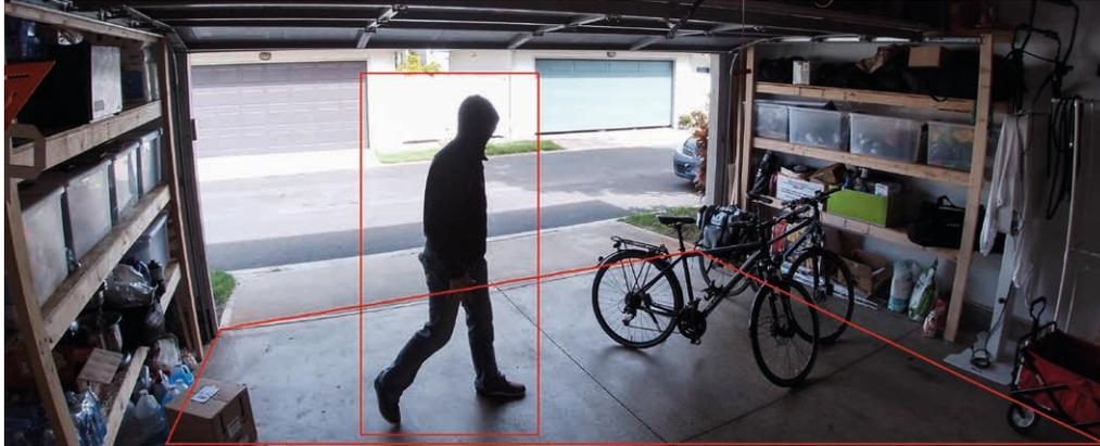
Die Erkennungsfunktion „Bereich betreten“ erlaubt die genaue Definition von Bereichen. Das Betreten des definierten Bereichs löst eine Alarmmeldung aus. Das sich bewegende Objekt wird als Person, motorisiertes oder nicht motorisiertes Fahrzeug klassifiziert. Für die Alarmreaktion stehen vier verschiedene Regeln zur Verfügung, die individuell anpassbar sind.
